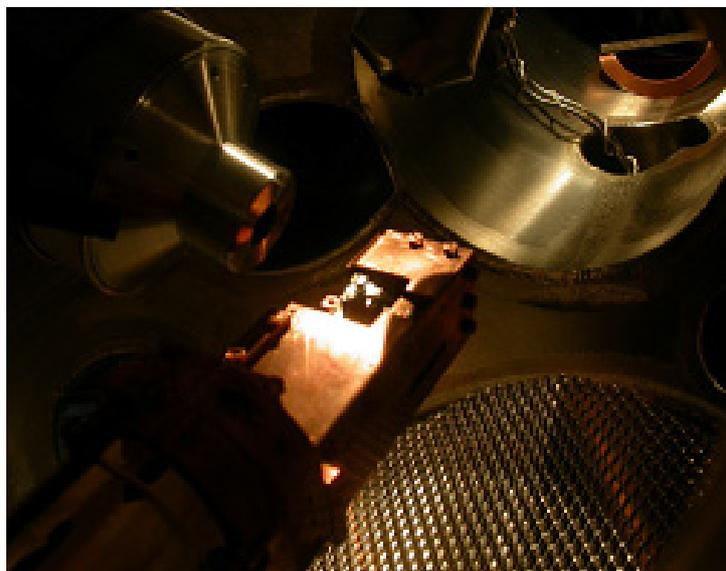
Abbildung 3.4: Manipulator mit Probe unter Analysator (links)
